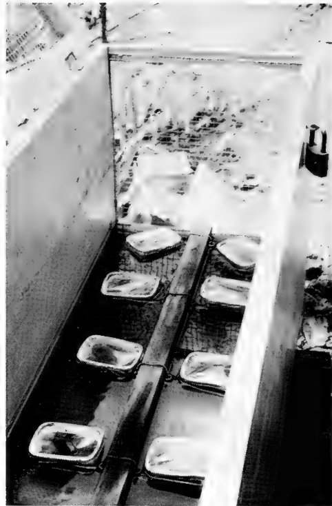
Abb. 6 Fließrinne mit Aufzuchtboxen für die Chironomidenlarven und Chironomidenpuppen am Ufer des Kalengos.
